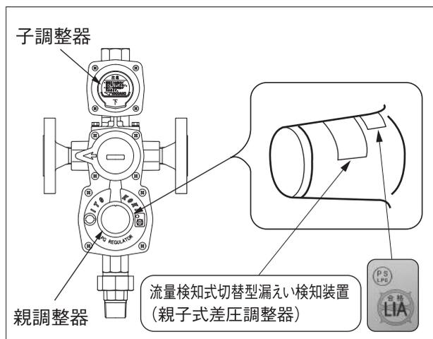
調整器合格証票および漏えい検知装置専用であることを示すシールが貼付されていることを確認してください。
