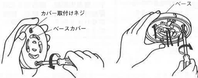
1. 本体からベースを取り外し、カバー取付けネジをゆるめてベースカバーをはずします。
