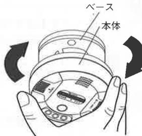
4. 警報器本体をベースに合わせ、止まる位置まで右に回し確実に固定します。
